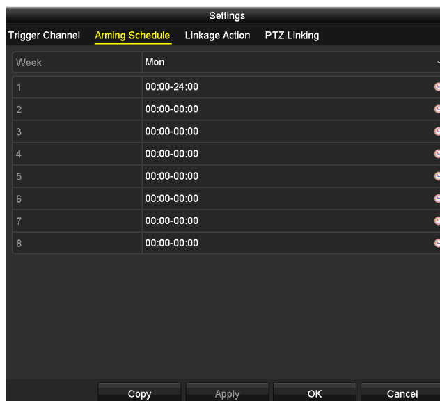
Figura 8-8 Setarea programului de armare a intrării alarmei
