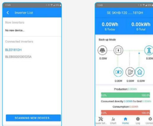
3. Apasati 'SCANNING NEW DEVICES...'. In cateva momente va fi afisat un dispozitiv nou in sectiunea 'New Inverters'. Apasand pe el acesta se muta in sectiunea 'Connected devices' si se deschide pagina de management ca in imaginea alaturata.
