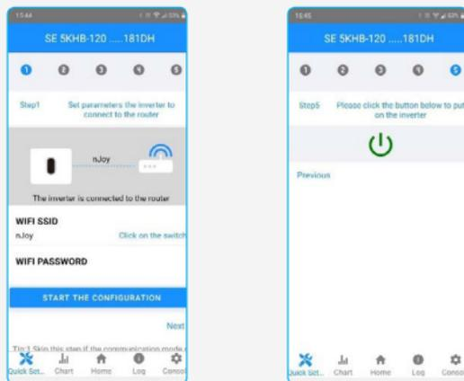
4. Odata ajuns in pagina Quick Setup, NU MODIFICATI NIMIC, puteti compromite monitorizarea de la distanta a invertorului!. Din partea superioara cu butoane numerotate de la 1 la 5, selectati butonul 5. Va apare fereastra de unde se poate porni sau opri invertorul, apasand pe simbolul afisat (daca simbolul e verde, invertorul se va porni, daca e rosu se va opri.)
