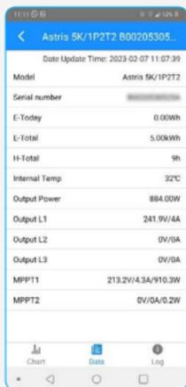
Cu butonul 'Data' se obțin informații tehnice despre invertor (model, S/N, putere furnizată, temperatura, tensiunea de ieșire, tensiunea de intrare de la panourile solare, etc.)
