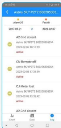
Butonul 'Log' permite vizualizarea evenimentelor aparute în funcționarea invertorului, atât notificări sau alarme (evenimente non-critice), cât și erori și avarii care sunt critice pentru buna funcționare a invertorului.
