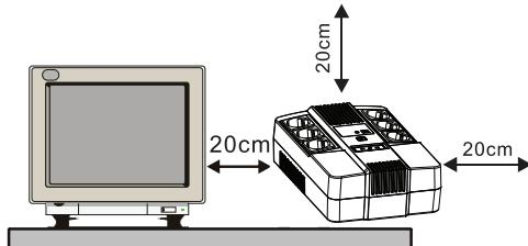
În plus, trebuie rezervat un spațiu de cel puțin 20 cm în jurul UPS-ului (inclusiv partea superioară) pentru a evita interferențele cu dispozitivele din jur și pentru a asigura disiparea căldurii.
